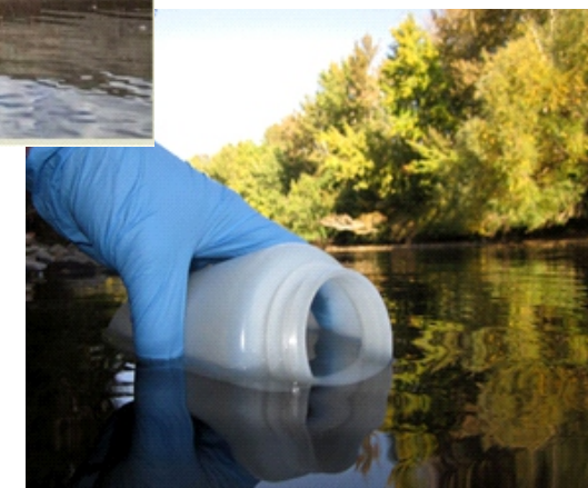
شکل ۹- نمونه برداری از آبهای سطحی
